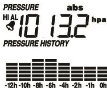
Appuyez cinq fois sur le bouton **MENU** pour sélectionner la section PRESSURE (pression), les chiffres de la section PRESSURE se mettent à clignoter. Appuyez sur le bouton **UP** ou **DOWN** pour basculer entre l'affichage de la pression atmosphérique relative et absolue.
