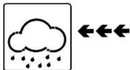
Le seuil d'orage peut être configuré pour s'adapter aux besoins de prévisions orageuses de l'utilisateur ; ce seuil est réglable de 5 à 9hPa (le réglage par défaut est de 4hPa). Lorsque la pression atmosphérique passe sous le seuil déterminé dans une période de 3 heures, l'icône de nuages avec pluie ainsi que les flèches de tendance se mettront à clignoter pendant 3 heures pour vous avertir que l'alerte orage a été activée.
